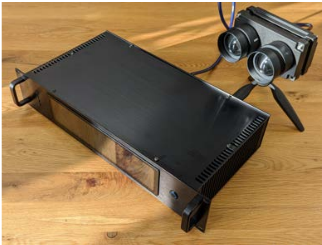
Radio On Light®で使用する光送受信モジュール、通信コントローラー
